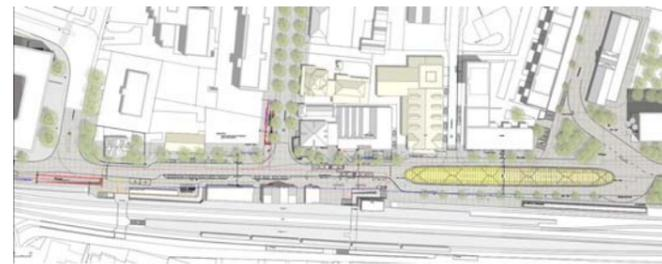
Bild: Aufsicht Bahnhofplatz mit Bushof Dach (gelb) und unterirdischer Velostation
